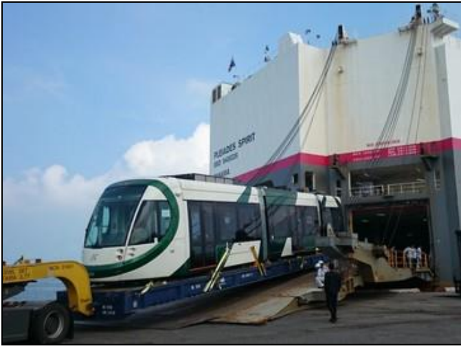
★高雄 9月にスペインから車両が到着(CAF・URBOS) 2015年秋に8.7km(全計画22.1km)の路線開業 スーパーキャパシタ搭載による架線レス運行 ★台北・新北(淡水区)で10月着工 2017年開業
