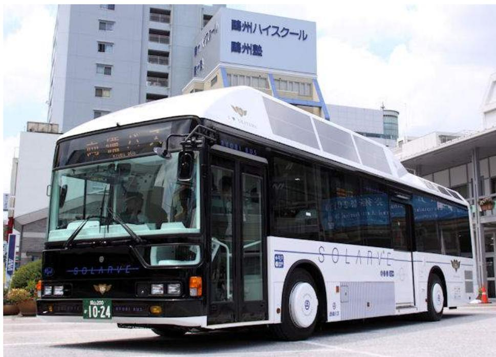
話ですが岡山には今、世界で一番地球に優しいハイブリッド路線バスが走っているのを皆様にご存知でしょうか。その名は「SOLARVE（ソラビ）」号。白を基調とした車体で屋根には大きなソーラーパネルを搭載されている目立つバスなので、街中で見かけた方も多いのではないのでしょうか。実はこのハイブリッド路線バス、屋根に搭載されたソーラーパネルで作られた電気を室内灯（しかもLED）に使用しているのです。世界初の試みで環境に配慮された、晴れの国ならではの自慢の路線バスです。車内も白で統一され、ユニバーサルデザインを施した内装となっており、窓には紫外線（UV）カットフィルムを使用し、女性にも優しいバスとなっています。”現在岡山駅～西大寺（東区）間1日4往復を中心に運行されていますので是非ご乗車してみてください下さい。”
