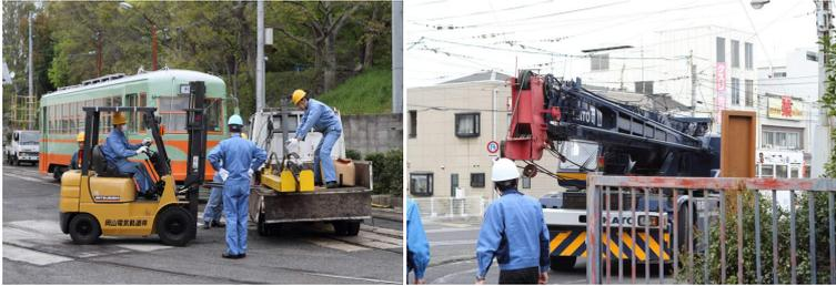
8:58 - 運搬に使われる大型トラックが到着。台車と車体を分離して運搬する都合、2台のトラックが用意されました。
